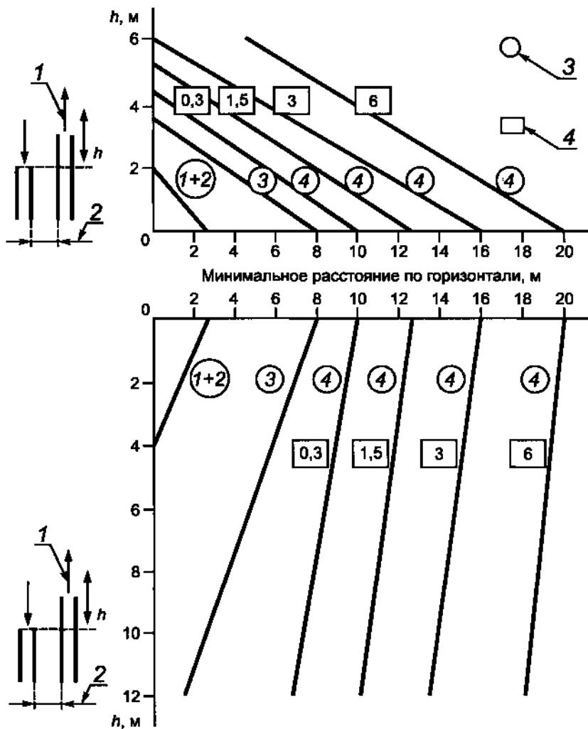
1 - расстояние по вертикали - устройство для удаления воздуха за пределы здания находится выше приемного устройства наружного воздуха (верхний график), расстояние по вертикали - устройство для удаления воздуха за пределы здания находится ниже приемного устройства наружного воздуха (нижний график); 2 - расстояние; 3 - класс ЕНА; 4 - расход воздуха в устройстве для удаления воздуха за пределы здания,  $\text{м}^3/\text{с}$
