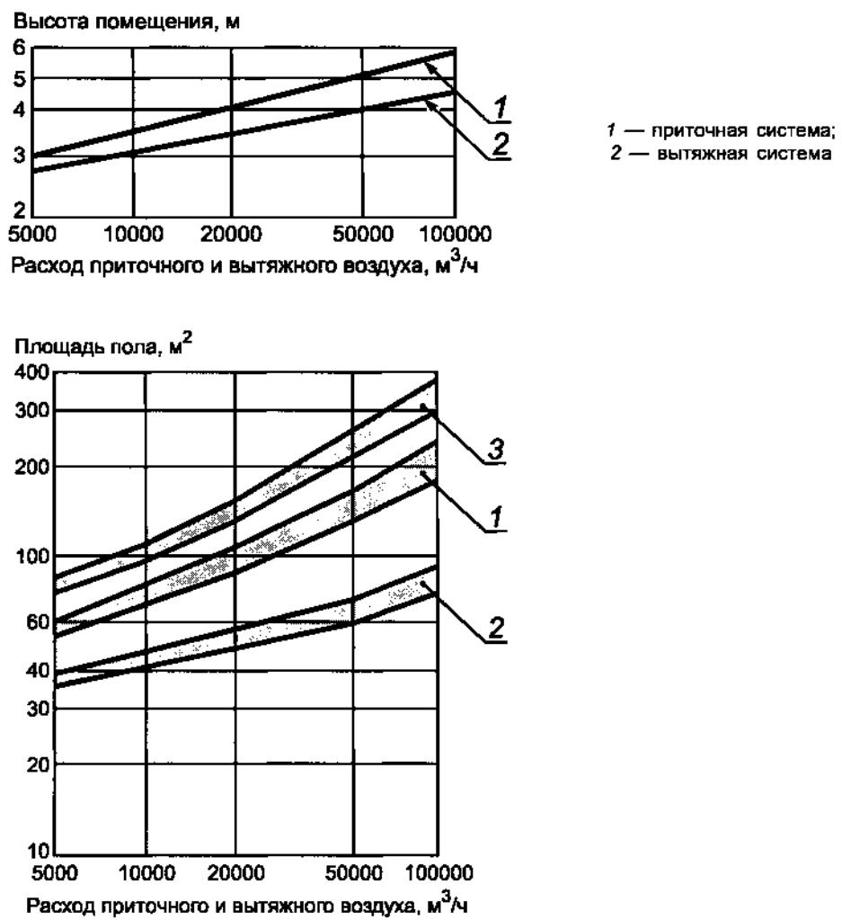
1 - только приточная система; 2 - только вытяжная система; 3 - приточная и вытяжная системы
