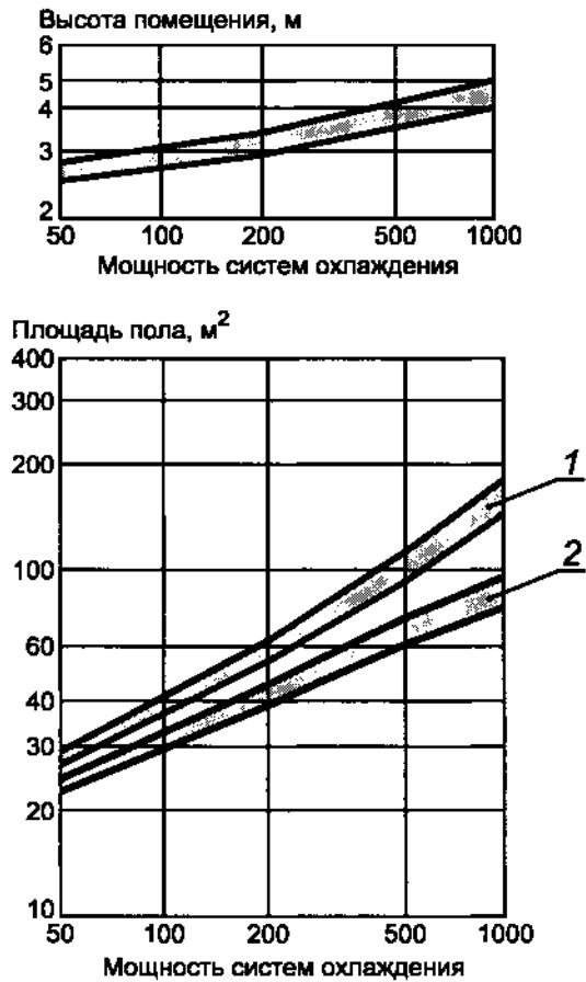
1 - система охлаждения, включая распределение воды; 2 - система повторного охлаждения
