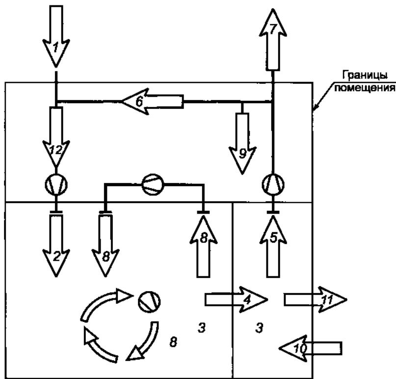
Рисунок 1 - Типы потоков воздуха. Номера позиций соответствуют таблице 2
