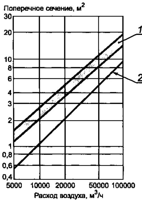
1 - шахты для воздуховодов; 2 - шахты, непосредственно используемые в качестве воздуховодов
