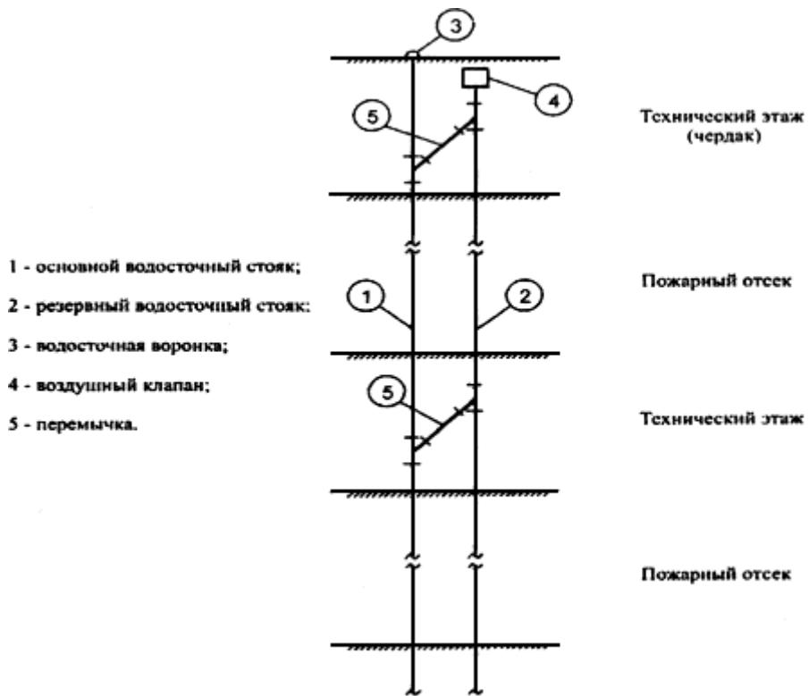
Рис.8.1. Схема водостока с устройством резервного стояка
