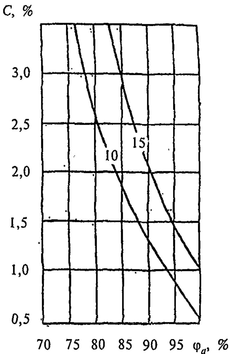
**Рисунок Щ.6 — Изолинии сорбционного влагосодержания керамзитобетона  $\rho_0 = 1200 \text{ кг}/\text{м}^3$ , содержащего  $\text{NaCl} — 30 \%$ ,  $\text{KCl} — 60 \%$ ,  $\text{MgCl}_2 — 10 \%$ , при изменении относительной влажности воздуха  $\phi_a, \%$ , и массового солесодержания  $C, \%$ , в стенах цехов сушки**
