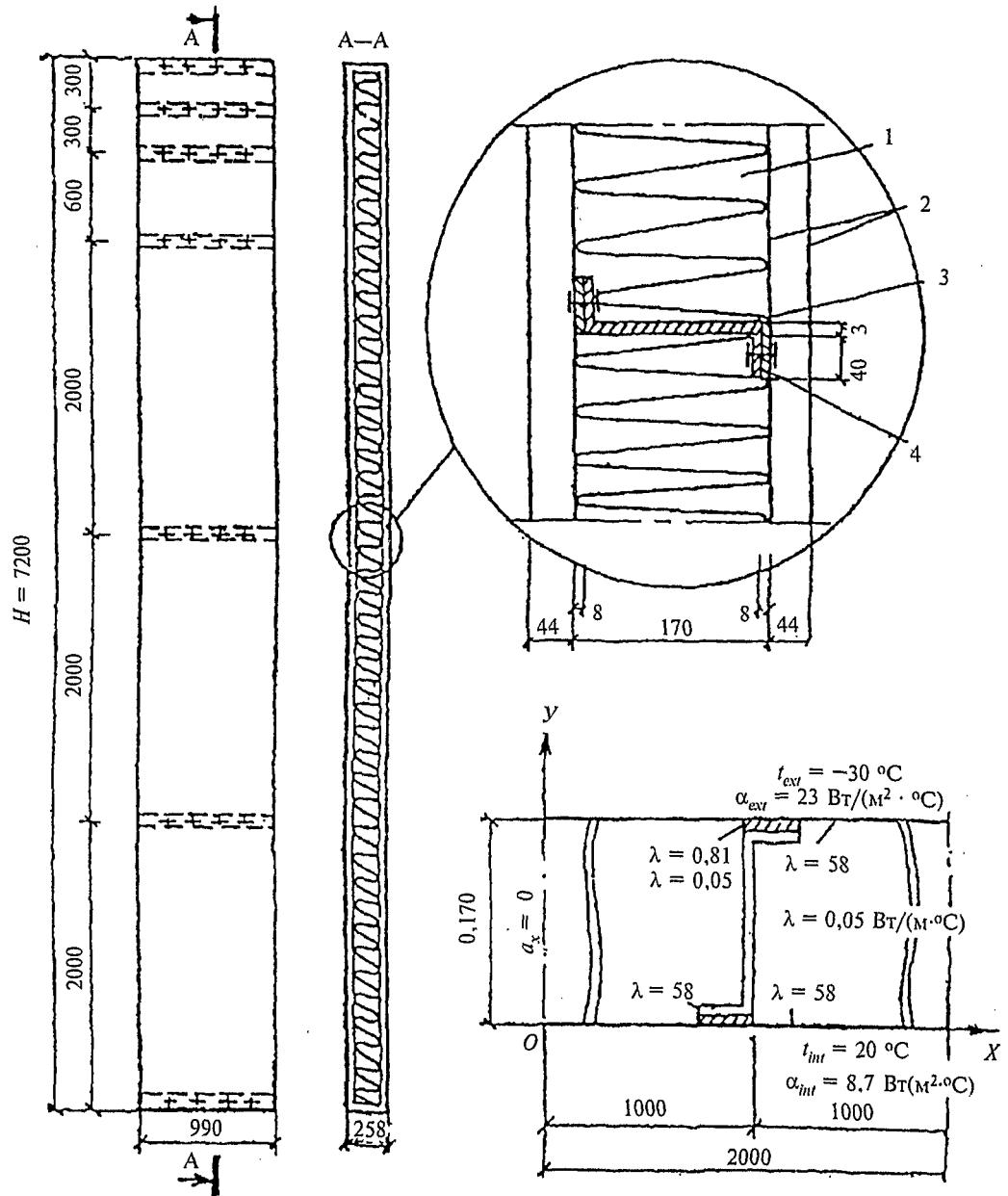
1 — минераловатные плиты; 2 — профилированные стальные профили; 3 — стальные профили; 4 — фанерные прокладки
