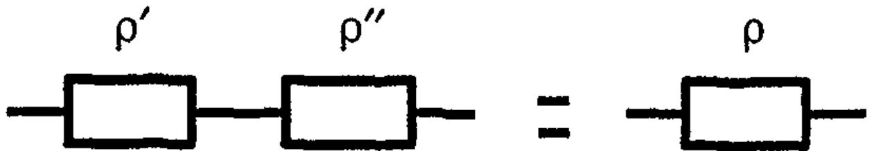
"Рис. 1. Цепь последовательно соединенных тепловых сопротивлений"
