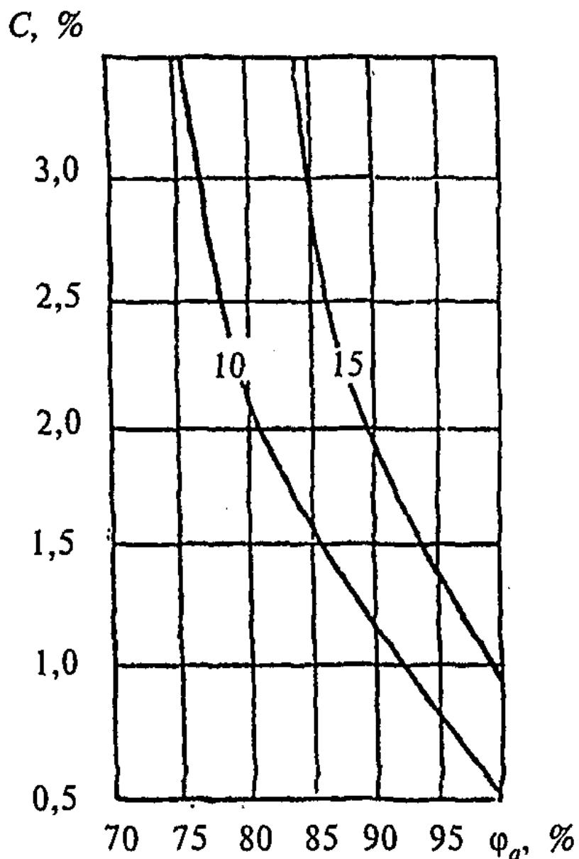
**Рисунок III.5 – Изолинии сорбционного влагосодержания керамзитобетона  $\rho_0 = 1200 \text{ кг/м}^3$ , содержащего  $\text{NaCl} – 50 \%$ ,  $\text{KCl} – 30 \%$ ,  $\text{MgCl}_2 – 10 \%$ , при изменении относительной влажности воздуха  $\phi_a, \%$ , и массового солесодержания  $C, \%$ , в стенах цехов дробления руды**
