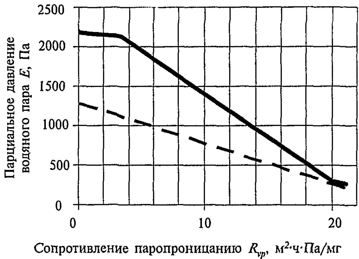
— — — — — распределение действительного парциального давления водяного пара  $e$
