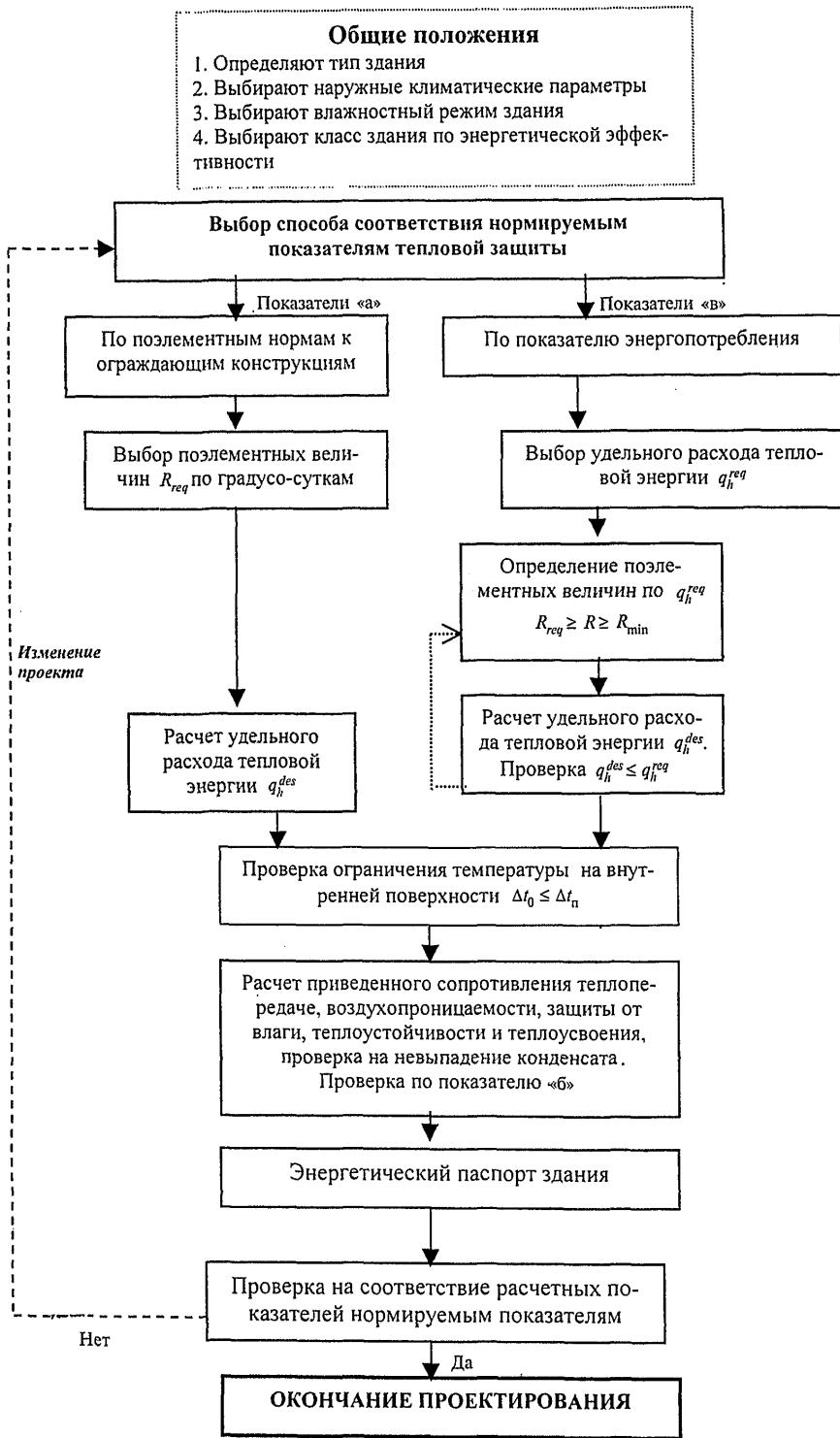
Рисунок 1 — Схема проектирования тепловой защиты зданий
