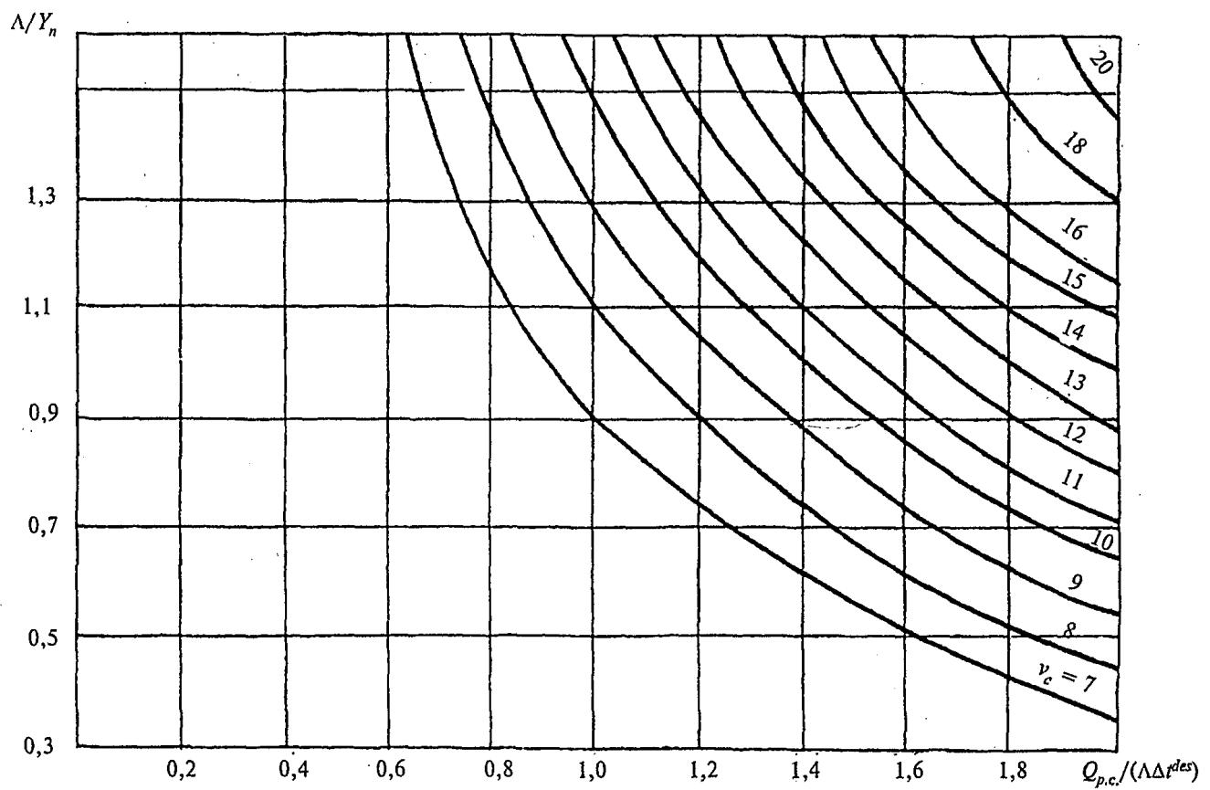
**Рисунок 3 — График для подбора теплоаккумулирующих приборов
