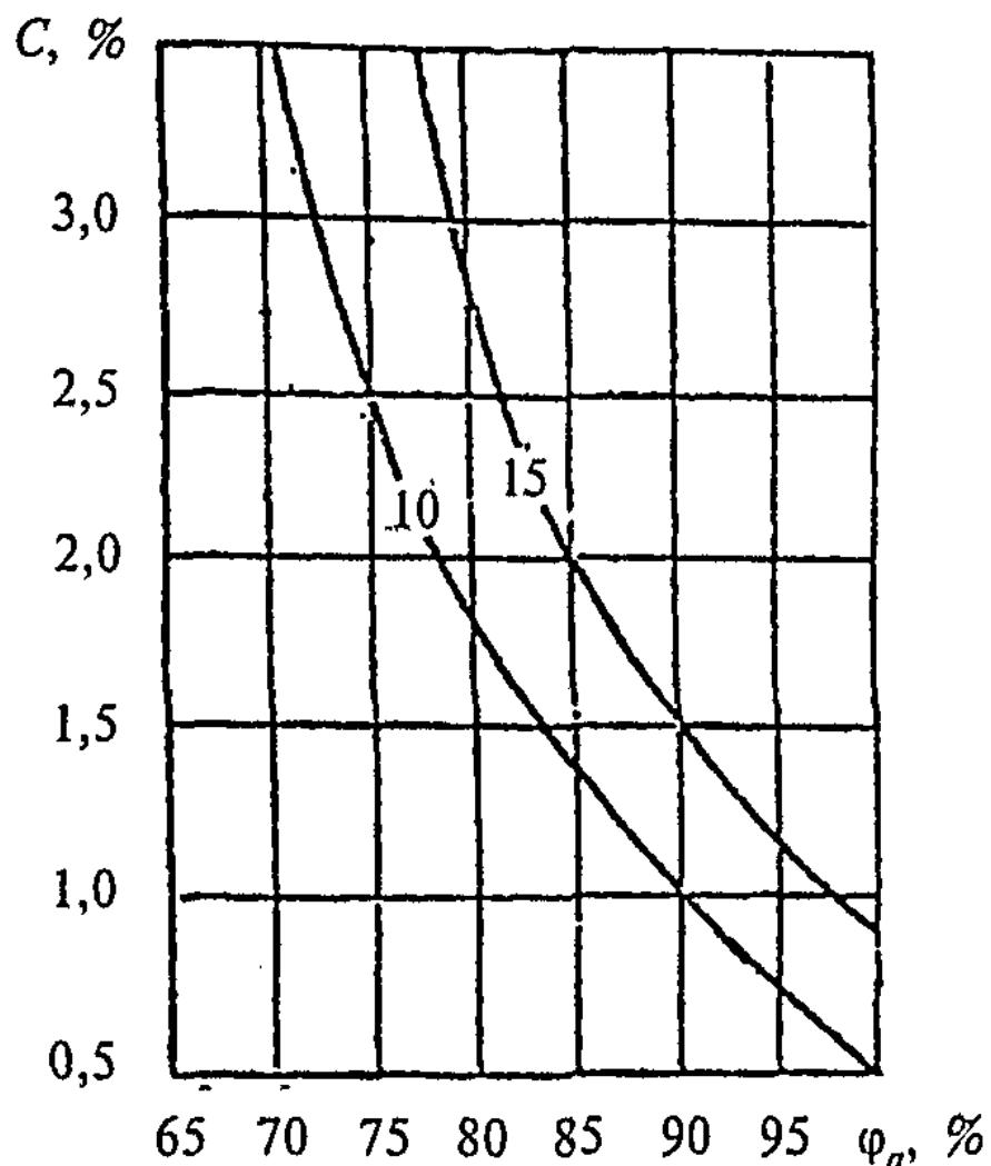
**Рисунок Щ.1 — Изолинии сорбционного влагосодержания керамзитобетона  $\rho_0 = 1200 \text{ кг}/\text{м}^3$ , содержащего хлорид натрия, при изменении относительной влажности воздуха  $\varphi_a, \%$ , и массового солесодержания  $C, \%$**
