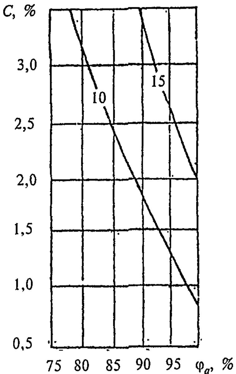
**Рисунок ІІ.3 — Изолинии сорбционного влагосодержания керамзитобетона  $\rho_0 = 1200 \text{ кг}/\text{м}^3$ , содержащего хлорид магния, при изменении относительной влажности воздуха  $\phi_a$ , %, и массового солесодержания  $C$ , %**
