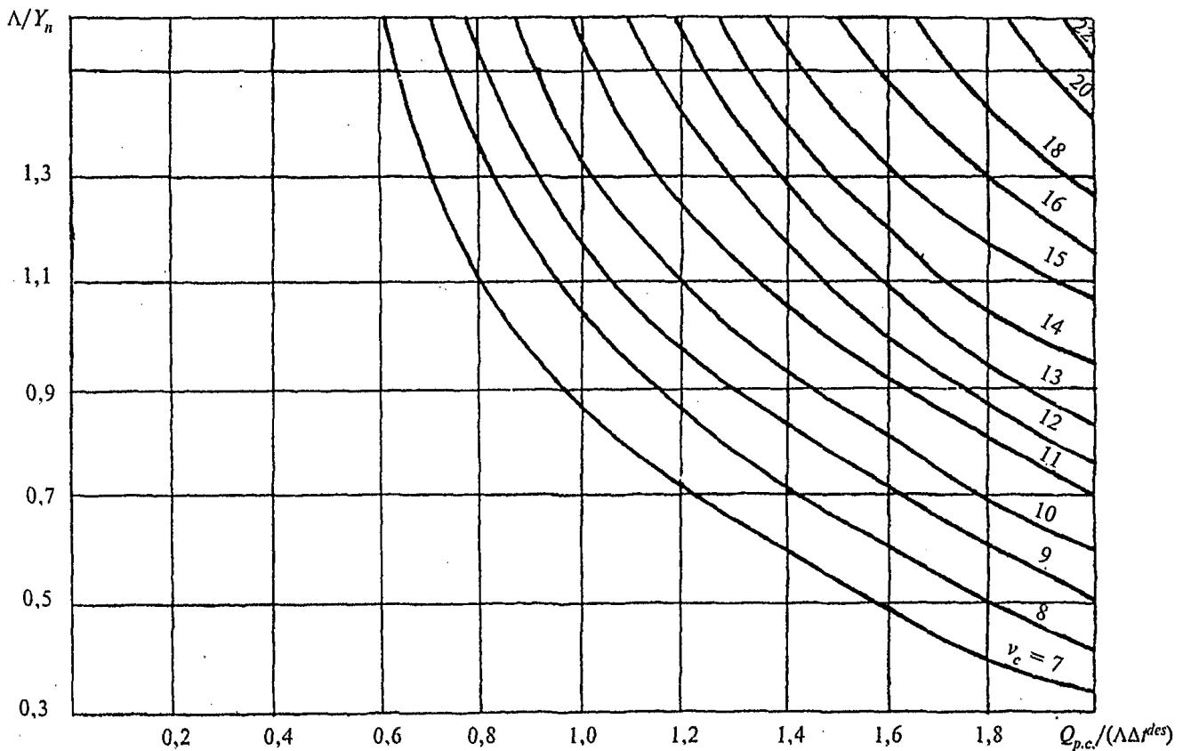
**Рисунок 4 — График для подбора теплоаккумулирующих приборов
