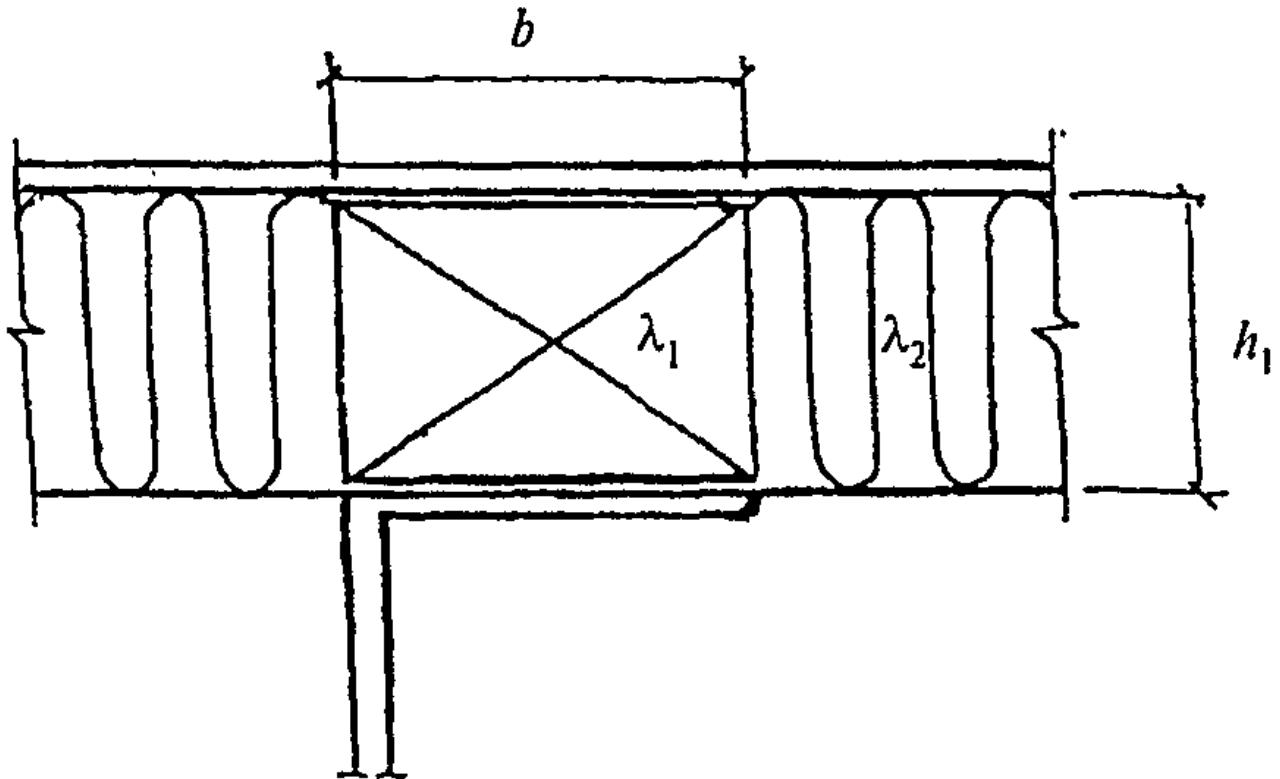
"Рис. 9. Теплоизоляционный слой"
