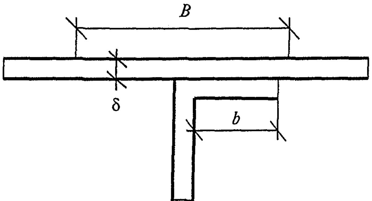
"Рис. 3. Примыкание полки профиля к облицовочному металлическому листу"
