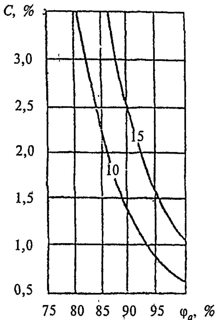
**Рисунок ІІ.2 —** Изолинии сорбционного влагосодержания керамзитобетона  $\rho_0 = 1200 \text{ кг}/\text{м}^3$ , содержащего хлорид калия, при изменении относительной влажности воздуха  $\phi_a, \%$ , и массового солесодержания  $C, \%$
