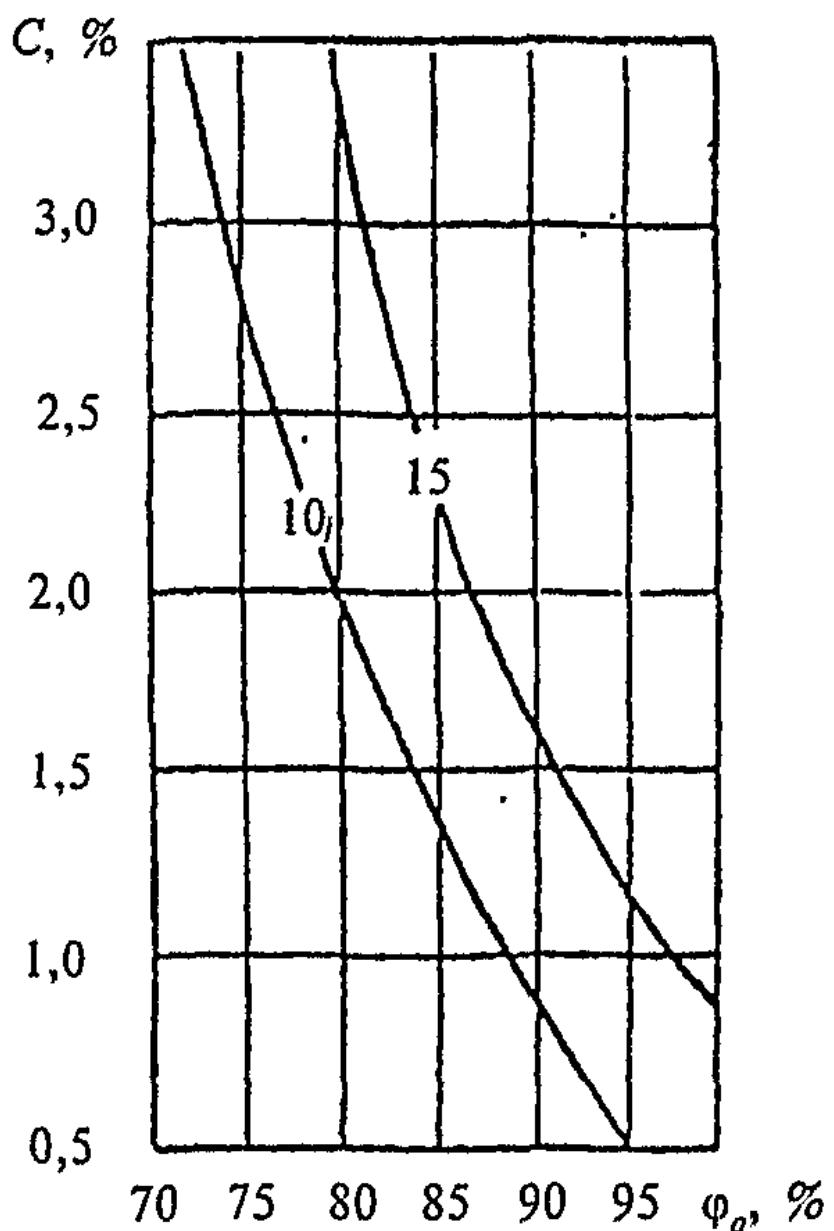
**Рисунок Щ.4 — Изолинии сорбционного влагосодержания керамзитобетона  $\rho_0 = 1200 \text{ кг}/\text{м}^3$ , содержащего NaCl — 60 %, KCl — 30 %, MgCl<sub>2</sub> — 10 %, при изменении относительной влажности воздуха  $\varphi_a, \%$ , и массового солесодержания C, %, в стенах флотофабрик**
