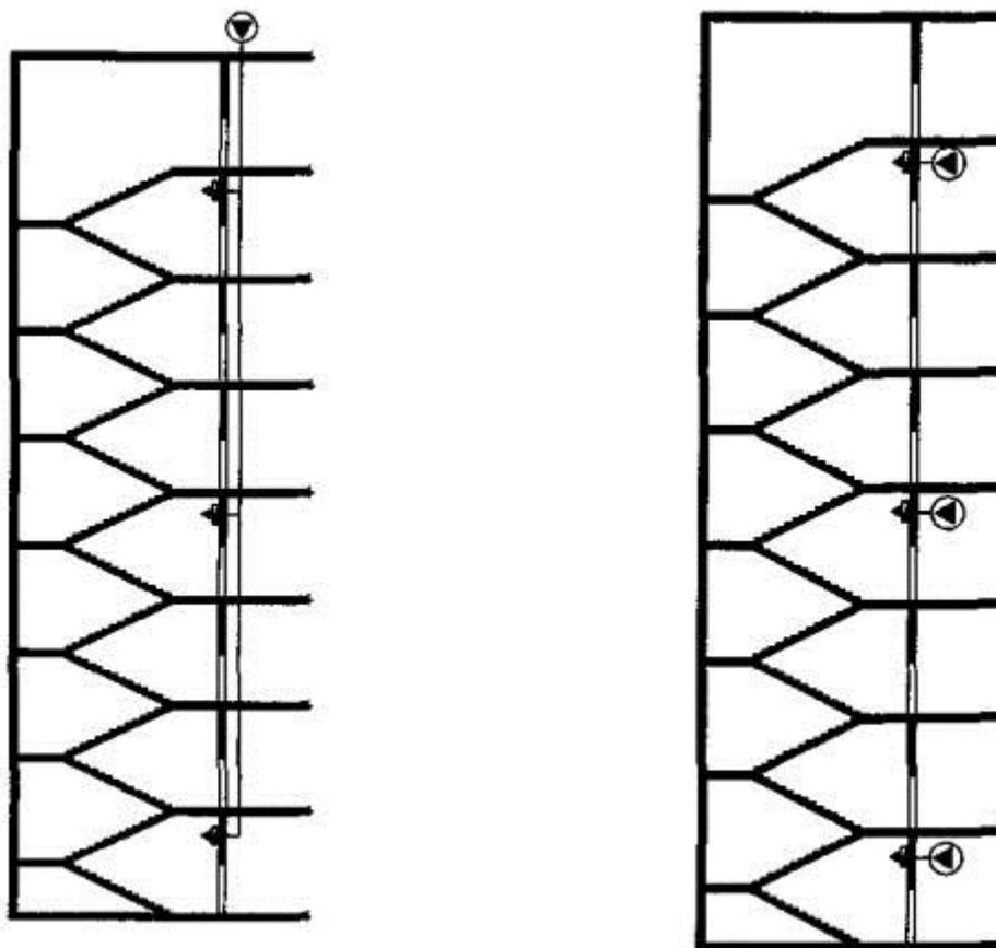
Рис. 4. Схема распределенной подачи воздуха в лестничную клетку:
