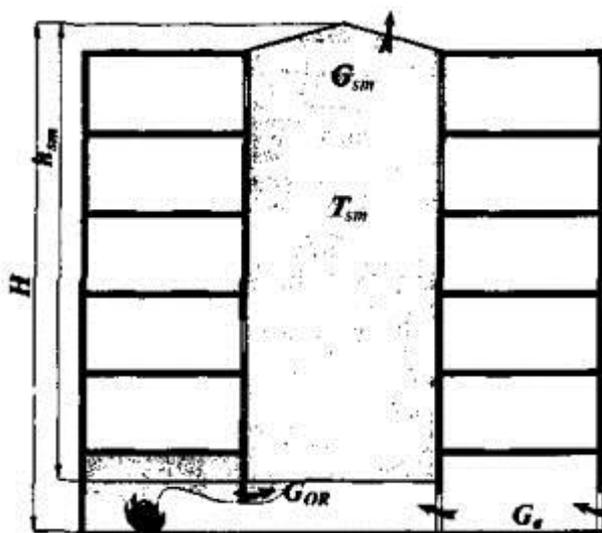
Рис. 2. Расчетная схема газообмена при пожаре в атриуме с конструктивно неотделенными галереями (а) и с конструктивно отделенными этажами (б)
