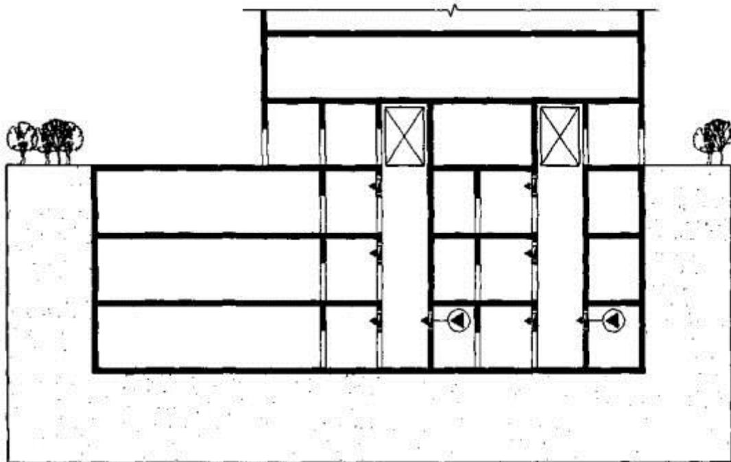
*Рис. 5. Схемы подачи воздуха в лестничные клетки (а) и в лифтовые шахты (б) подземной части здания*
